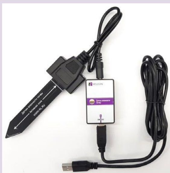
Рис. 4. Датчик влажности почвы
